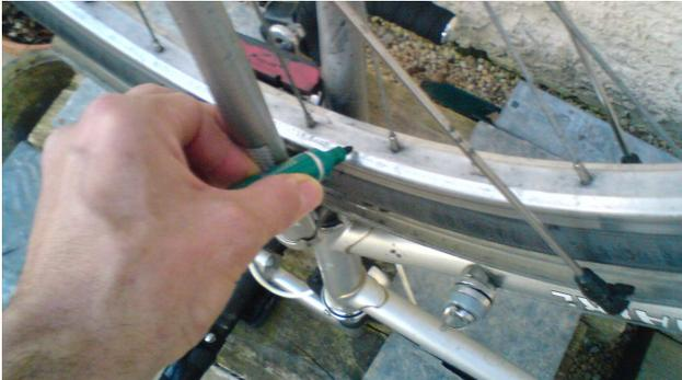
B/ Avancer progressivement la pointe du feutre vers la jante jusqu'à ce qu'elle entre en contact avec la surface proche des rayons. Le feutre va laisser sa trace sur les parties rentrantes de la jante et rien dans les parties sortantes (...normal...)
