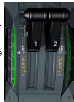
Le système d'automanette commande la poussée des moteurs correspondant aux modes de poussée et aux limites actives de poussée. Les leviers de poussée des A319/320/321 ne sont pas pilotés en arrière par le système d'automanette, et ne se déplacent pas pendant que la poussée est automatiquement ajustée. À moins que nécessaires, ils sont laissés sur « CL » jusqu'à ce que la voix synthétisée annonce "RETARD" à 20 pieds au-dessus de piste d'atterrissage.
