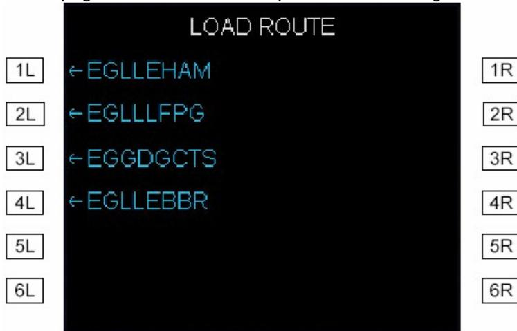
Sélectionner n'importe quel plan de vol de la liste ouvre la page de confirmation LOAD ROUTE. Cette page affiche le listing du plan de vol sauvegardé, et fournit des options pour l'insertion de la route dans un plan de vol actif, ou pour annuler la sélection. Cette page est aussi affichée quand une entrée est faite au prompt CO RTE de la page INIT, et qu'un plan de vol correspondant au nom entré existe.
