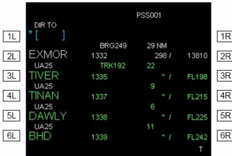
Le point validé en 1L active la fonction Direct To, à la position courante de l'avion.
