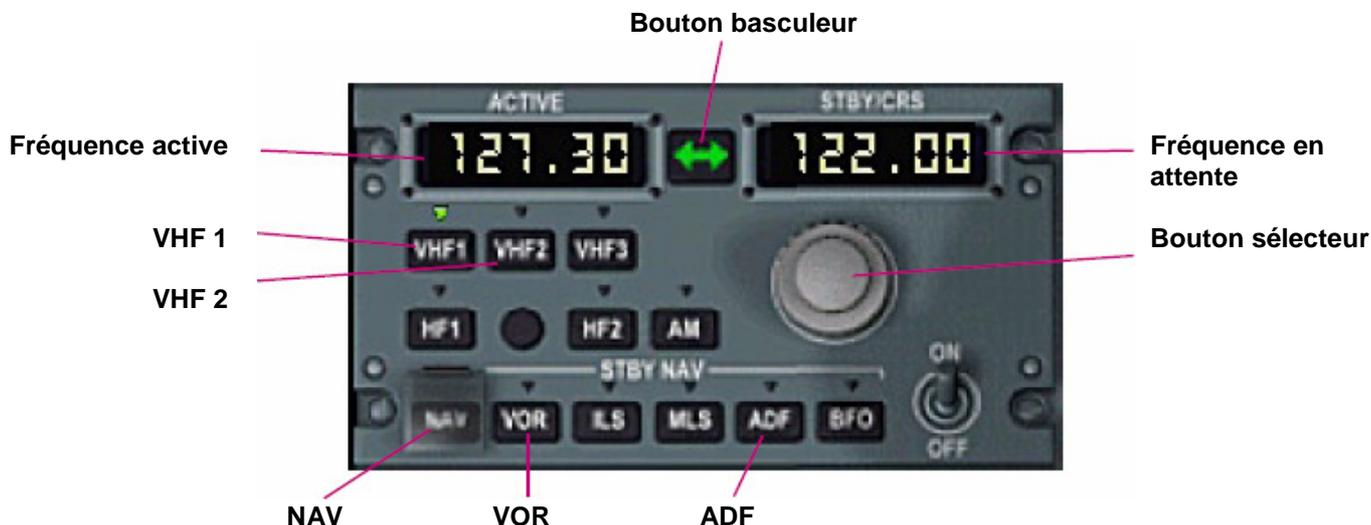
**Fréquence active.** Cette fenêtre affiche la fréquence active de la radio sélectionnée. La fréquence active ne peut pas être changée directement dans cette fenêtre.
