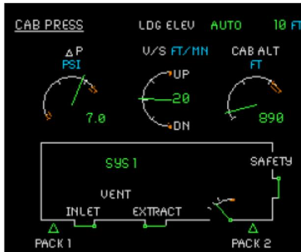
Cette page est utilisée pour contrôler les opérations du système de pressurisation.
