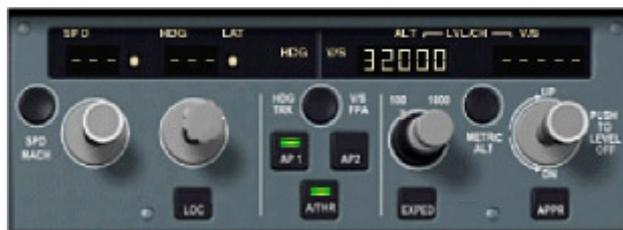
Les quatre boutons rotatifs sur le FCU permettent de contrôler la vitesse air, et les modes latéraux et verticaux. Chaque bouton peut être tourné, poussé ou tiré. Les boutons sont toujours initialement en position neutre.
