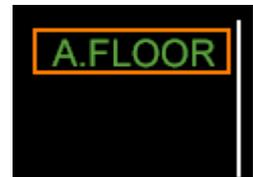
Pendant les conditions Alpha élevées, Le mode de plancher Alpha est le seul mode d'A/THR possible. Quand les conditions d'enclenchement n'existent plus, les leviers de poussée restent verrouillés sur TOGA. Ces conditions s'appellent TOGA LOCK. Pour déverrouiller les leviers de poussée, il faut désactiver l'A/THR en premier.
