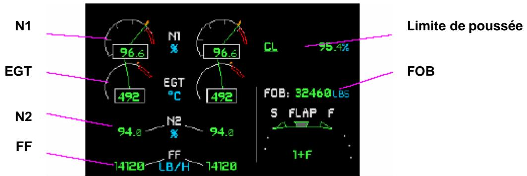
**N1 :** Vitesse du rotor de la turbine basse pression, en %
