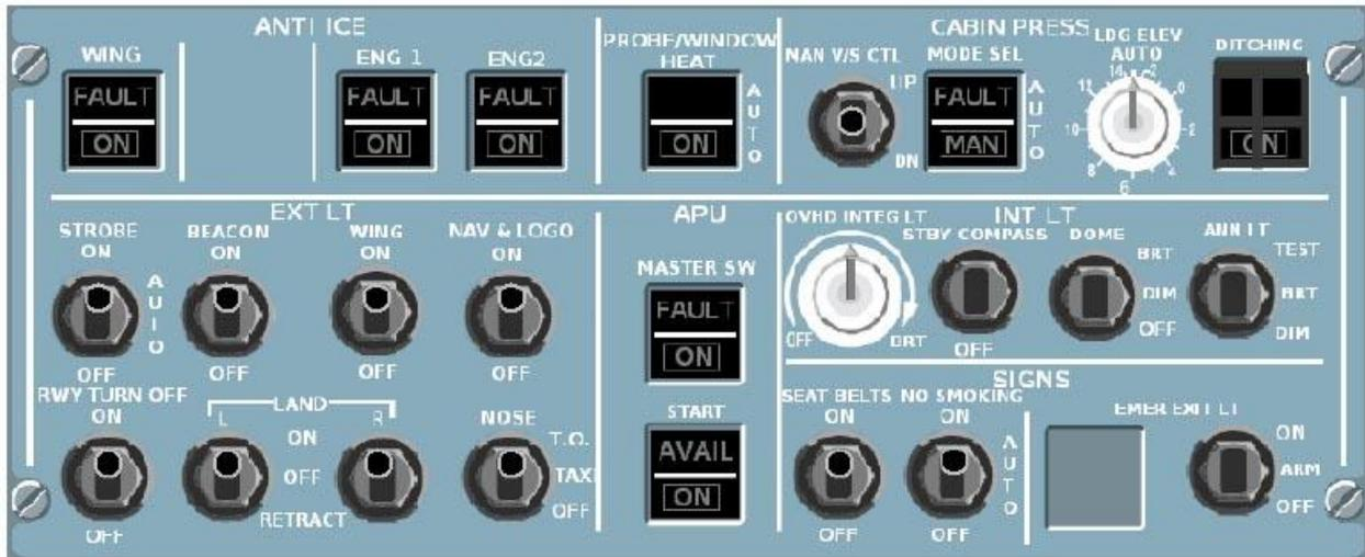
**ANTI ICE** : Pour actionner les dégivrages des ailes ou des moteurs, cliquez simplement sur le “Korry” correspondant. Le voyant bleu **ON** s’allumera.
