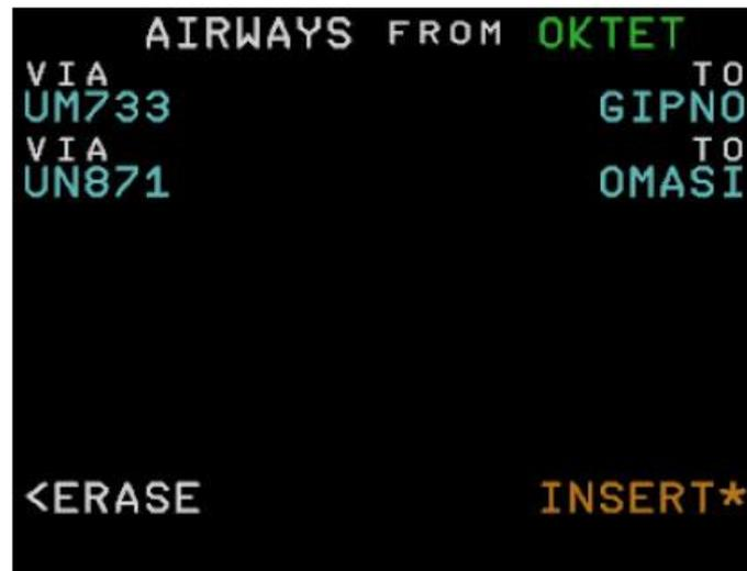
On y accède à partir de la page LAT REV FROM. Ces pages vous permettent d'insérer facilement au plan de vol, plusieurs points de route à la fois, suivant une route aérienne :
