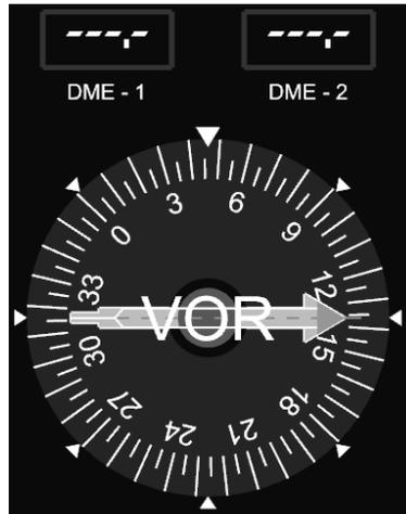
Le DDRMI (Digital Distance and Radio Magnetic Indicator) affiche les distances DME (si VOR1/VOR2 sont sélectionnés), ainsi que le relèvement du VOR ou de l'ADF sélectionné.
