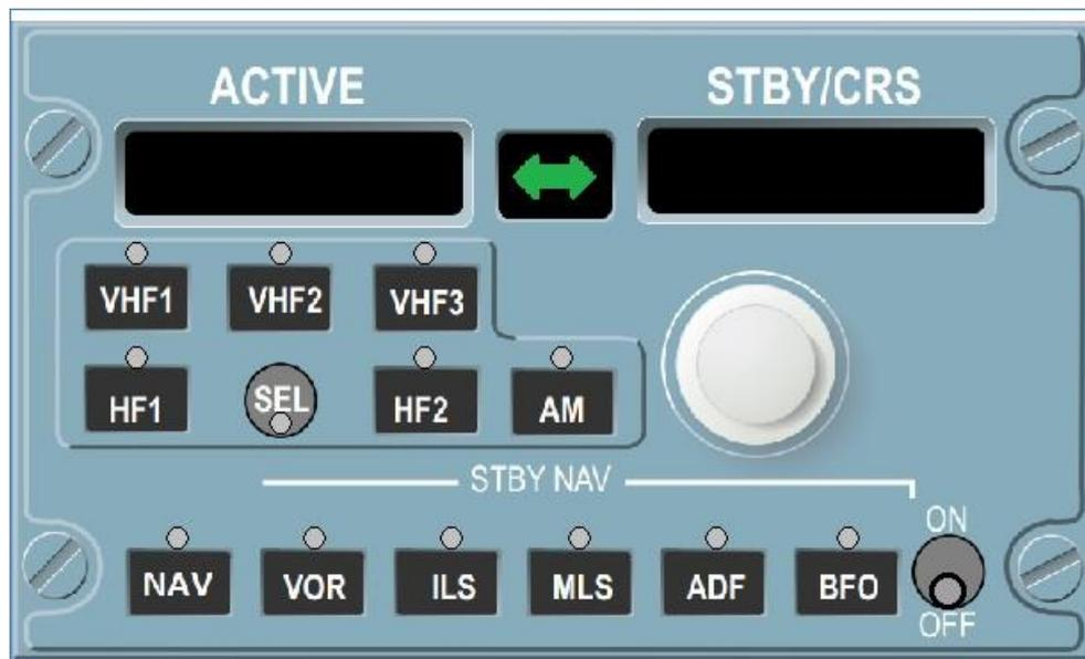
Ces panneaux permettent de contrôler les trois RMP (CPT, F/O et strapontin).
