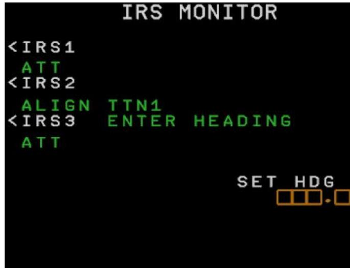
Cette page affiche le mode des trois IRS, et vous permet de vérifier l'état de chacun d'eux par les touches LSK1 à 3. Si un des IRS est en mode ATT et non aligné, vous pouvez entrer le cap ici, en 5R. Pour le moment, quel que soit le cap entré, seul le cap réel sera utilisé.
