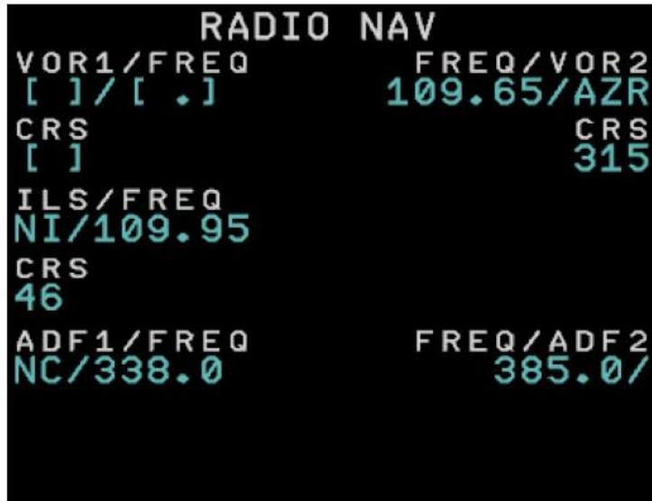
Cette page est appelée par le bouton **RAD NAV** du MCDU. Elle est utilisée pour régler les fréquences des équipements radio-électriques (VOR, ILS, NDB). Les Nav aids ne peuvent plus être réglées à partir de Flight Simulator ; des commandes via FSUIPC seront ajoutées ultérieurement.
