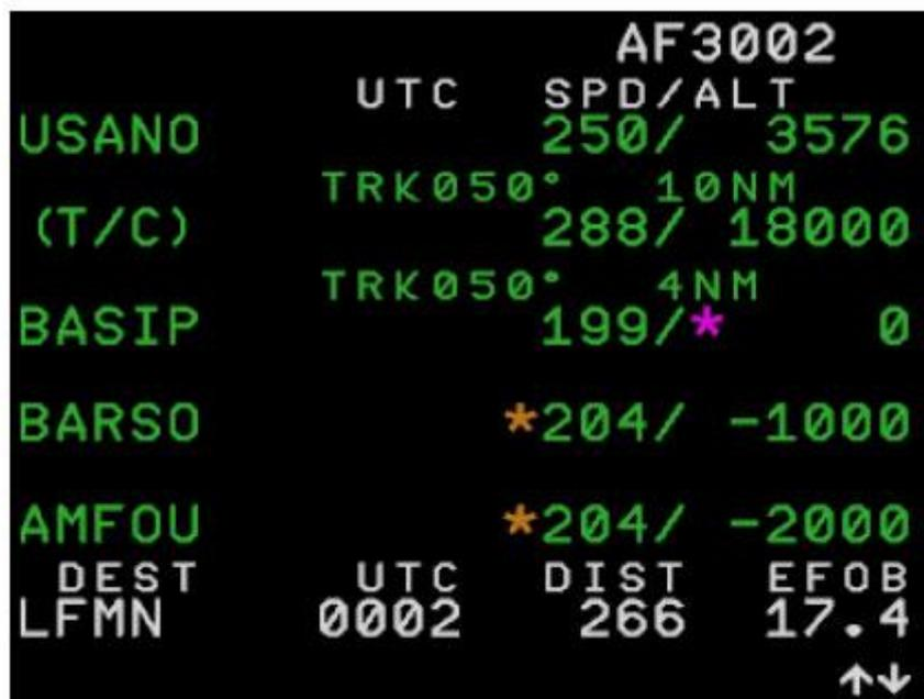
Les indications en petites lettres entre deux points indiquent le cap magnétique à suivre et la distance en milles nautiques entre les deux points.
