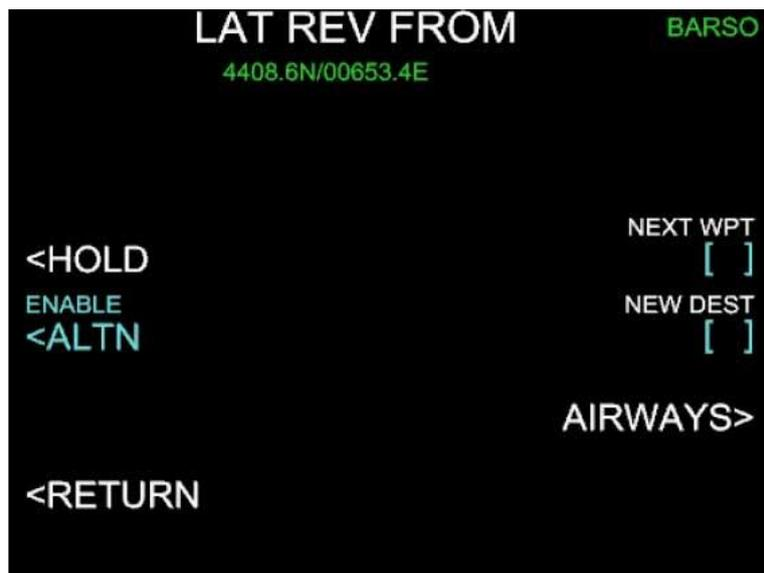
On y accède par les touches LSK1 à LSK5 de la page FPLN. Cette page permet de modifier la trajectoire horizontale de l'avion, à partir du point sélectionné.
