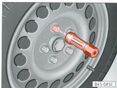
● Dévissez les boulons de roue (après les avoir desserrés) à l'aide de l'empreinte six pans de la poignée du tournevis (voir figure), déposez-les sur un support propre (enjolveur de roue, chiffon, papier) à côté du cric et retirez la roue.
