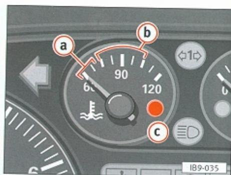
Si l'aiguille se trouve dans la moitié droite de la zone d'indication, cela signifie que la température du liquide de refroidissement est trop élevée. **Il faut s'arrêter, éteindre le moteur, attendre qu'il se refroidisse** et chercher la cause de l'anomalie. Voir chapitre "Système de refroidissement".
