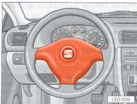
Le système de coussins gonflables de sécurité (airbags) complète l'effet protecteur des ceintures de sécurité trois points, il offre une protection supplémentaire pour la zone du crâne et du buste du conducteur et du passager avant en cas de collisions frontales graves.
