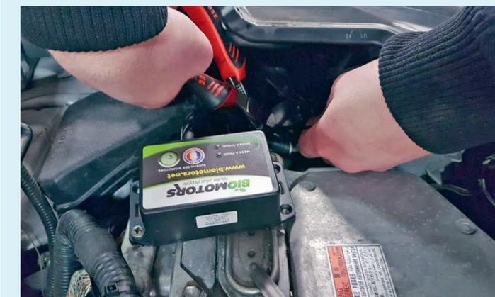
Calculer la part d'éthanol présente dans le carburant et ajuster les temps d'injection : c'est ce que font les « vrais » boîtiers homologués, comme celui de chez Biomotors.
